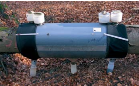
Eklektoren an liegenden Stämmen fangen die Tiere, die aus einem 1 m langen Stammabschnitt schlüpfen.
