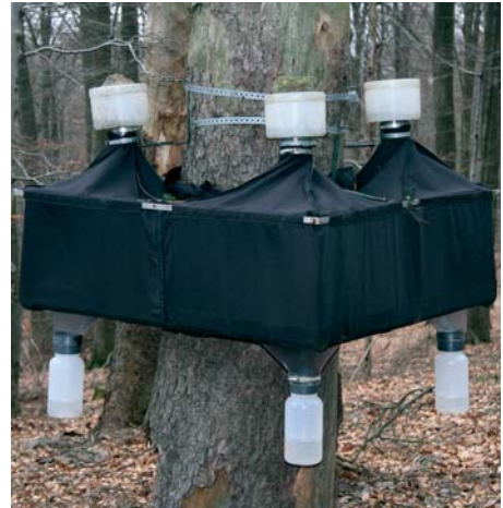
Der Stammeklektor fängt Tiere, die an einem stehenden Baumstamm nach oben wandern.
