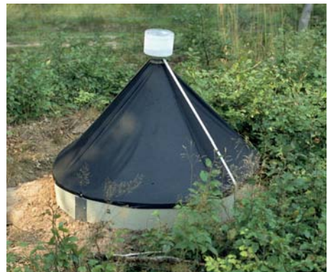
Der Stubbeneklektor fängt die Tiere, die aus einem Baumstumpf und dem ihn unmittelbar umgebenden Boden schlüpfen.
